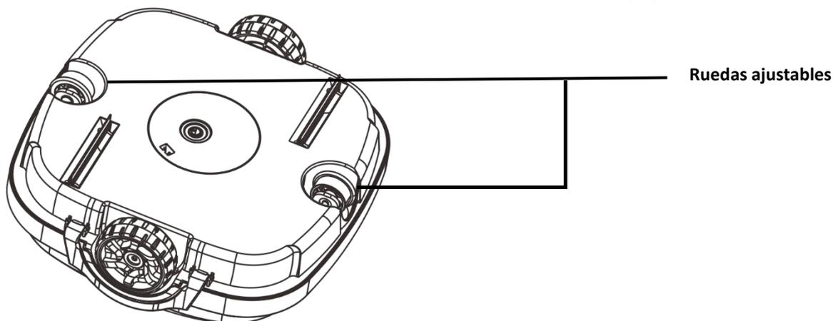
2. Para ajustar las ruedas, abra los cierres y retire la cubierta superior. Coloque las dos ruedas ajustables. Retire la rueda presionando el pestillo del vástago de rueda. Elija la combinación correcta e inserte la rueda hasta que el pestillo dé un sonido de "clic".
