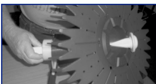
Membraninstrument mit Membran durch das Gerät ziehen, bis ein Plopgeräusch ertönt und es sich löst
