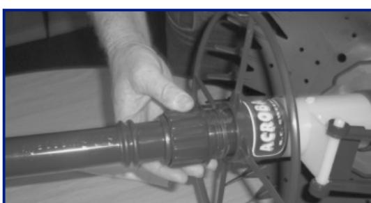
Volver a colocar el tubo de extensión exterior
