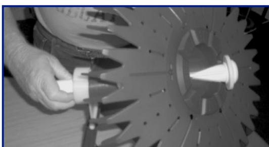
Pasar la herramienta del diafragma con el diafragma a través de la máquina hasta que aparezca en el otro extremo y soltar
