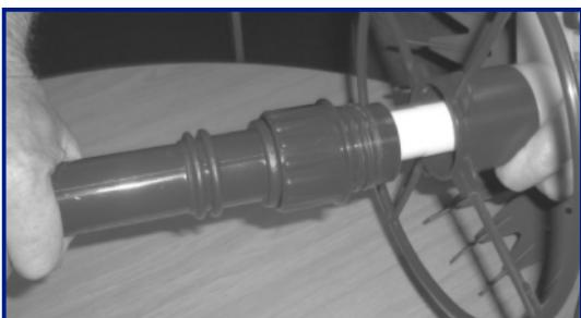
Tournez l'écrou dans le sens contraire des aiguilles d'une montre
