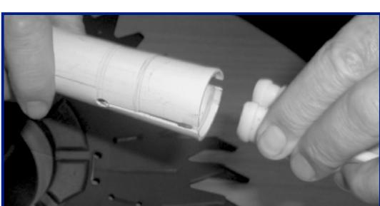
Collocare il disco giallo intorno alla membrana e fissarlo nell'utensile apposito
