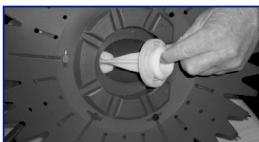
Remova do corpo do aparelho puxando através da base do aspirador
