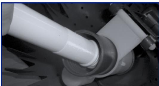
Innenverlängerungsrohr und Ablenkrad austauschen
