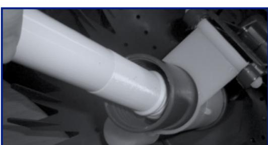
Sostituire il tubo di estensione interno e la ruota del deflettore
