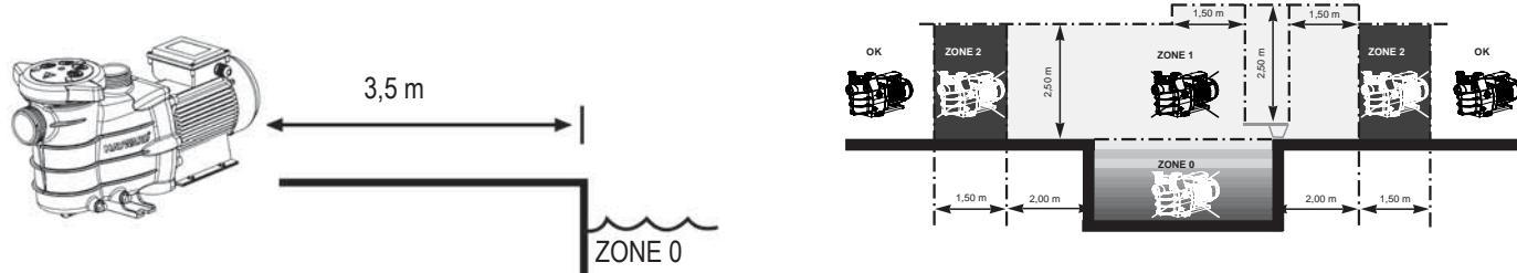
Instale a bomba num local arejado e seco: o motor exige que o ar circule livremente à volta da bomba de modo a obter-se uma ventilação natural.
