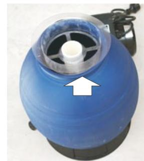
8 COLOCAR LA PIEZA CENTRADORA TRANSPARENTE EN LA BOCA DEL DEPOSITO Y VERTER LOS 19 KG ARENA EN EL FILTRO, ESTE TAPON EVITA QUE ENTRE ARENA EN EL COLECTOR.
