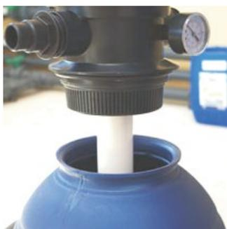
9 RETIRAR LA PIEZA CENTRADORA TRANSPARENTE, LIMPIAR CON UN TRAPO EL BORDE DE LA BOCA DEL FILTRO, PONER EN LA VALVULA (4) LA JUNTA TORCA E INSERTARLA EN EL TUBO DEL COLECTOR (6) Y LA BOCA DEL DEPOSITO DEJANDOLA BIEN AJUSTADA.
