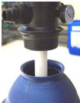
9 RETIRAR LA PIEZA CENTRADORA TRANSPARENTE, PONER EN LA VALVULA (4) LA JUNTA TORICA E INSERTARLA EN EL TUBO DEL COLECTOR (6) Y LA BOCA DEL DEPOSITO DEJANDOLA BIEN AJUSTADA.
