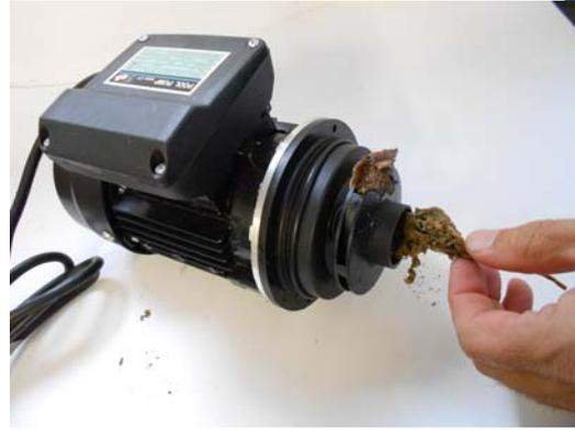
11. La turbina queda al descubierto y se limpia con unas pinzas u objeto que permita sacar la suciedad que la bloque, tanto en su interior como entre la turbina y la tapa posterior.
