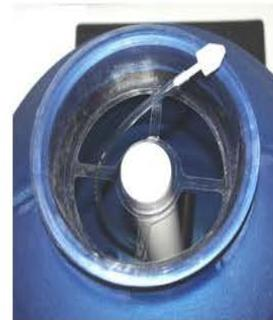
8 COLOCAR LA PIEZA CENTRADORA TRANSPARENTE EN LA BOCA DEL DEPOSITO, DEJAR FUERA EL TUBO DE PURGA Y LLENAR LA ARENA DEL FILTRO, ESTE TAPON EVITA QUE ENTRE ARENA EN EL COLECTOR.
