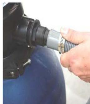
12 CONECTE EL OTRO LADO DEL MANGUITO (7) AL RACORD DE ENTRADA DE LA VALVULA Y APRETAR FIRMEMENTE LA BRIDA.
