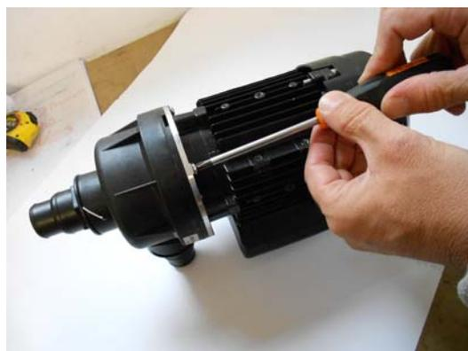
10. Con un destornillador fino de punta plana, suavemente recorrer la unión entre cuerpo y tapa de cuerpo (plástico, no metálico) para separar ambas partes de plástico.
