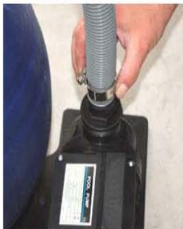
11 PONER LAS BRIDAS Y CONECTAR EL MANGUITO (7) AL RACOR DE IMPULSION DE LA BOMBA (1) Y APRETAR FIRMEMENTE LA BRIDA.
