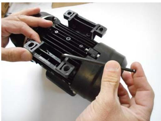
9. Con un destornillador de estrella, extraer los 4 tornillos que cierran el cuerpo de bomba.
