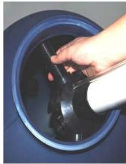
7 COLOCAR LAS CREPINAS (12) EN EL COLECTOR DENTRO DEL DEPOSITO
